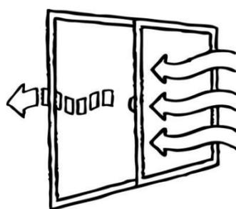
窓や玄関の断熱性能を高めましょう。内窓を設置する、断熱窓/ドアに交換する、などの方法があります。
